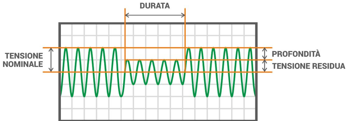
IL BUCO DI TENSIONE INIZIA QUANDO LA TENSIONE SI ABBASSA SOTTO IL 90% DELLA TENSIONE NOMINALE E FINISCE QUANDO TORNA SOPRA TALE VALORE
