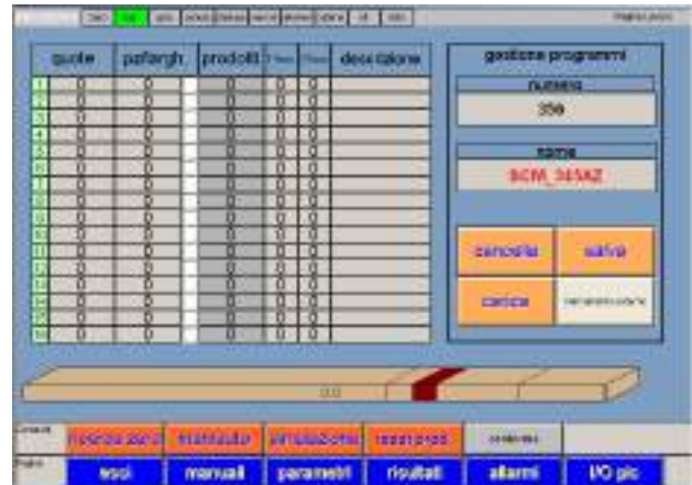
Una delle schermate del terminale operatore basato su Windows CE. Il terminale operatore normalmente è collegato sulla rete aziendale dalla quale attinge la lista dei pezzi da produrre.
