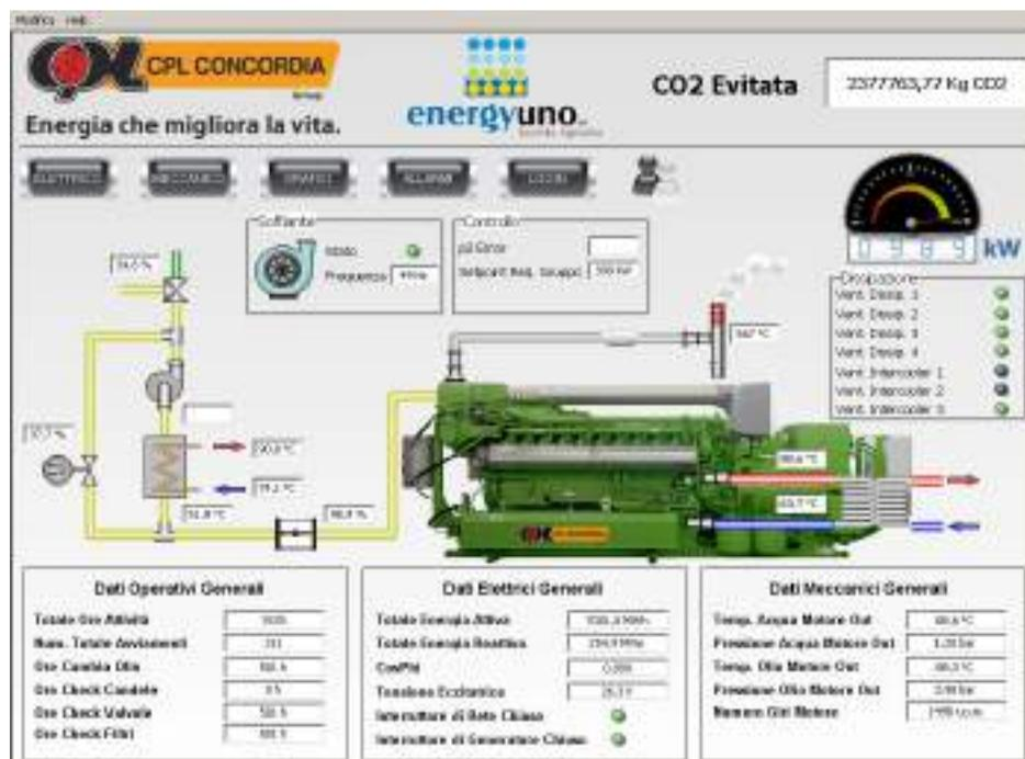
*Il sistema di supervisione dell’impianto si basa sulla piattaforma Scada/HMI Movicon 11 consente una facile gestione ed il completo monitoraggio, sia locale che via web.*
