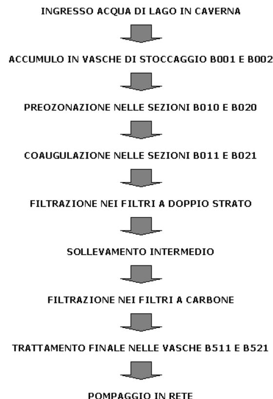
*Schema a blocchi del funzionamento dell'impianto.*
