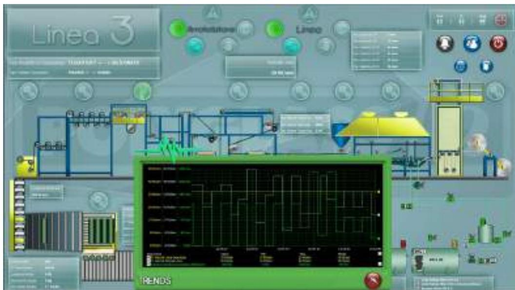
*La supervisione dello stabilimento principale, a Ponte di Piave, prevede un'architettura basata su Movicon 11 con una stazione server con monitor da 55" e nr 5 stazioni client, connesse sulla LAN aziendale.*
