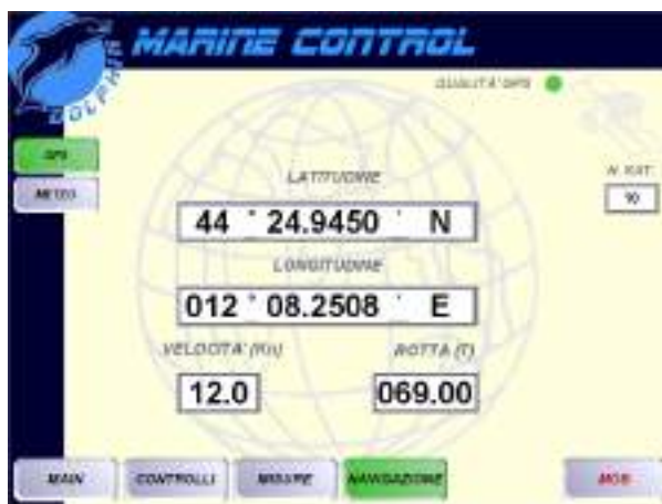
Dolphin, oltre a gestire gli I/O, integra le informazioni meteo, il sistema di localizzazione GPS e l'interfaccia con i motori di bordo (Caterpillar, Volvo...).
