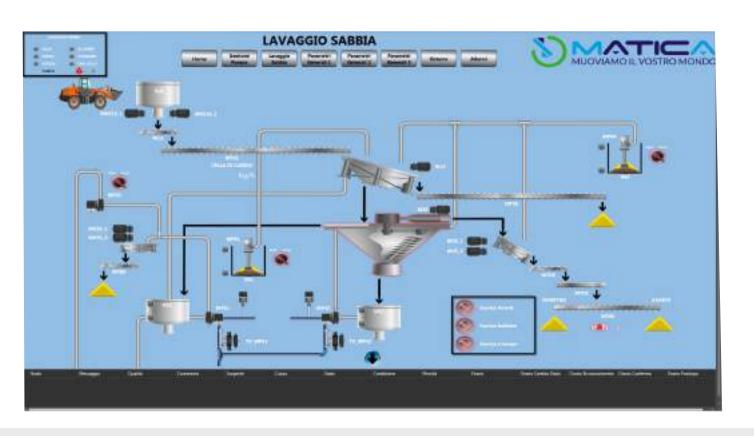
revamping dell'impianto si è optato di utilizzare uno SCADA di tipo commerciale. La scelta è caduta sulla piattaforma SCADA di Progea Movicon.NExT.
