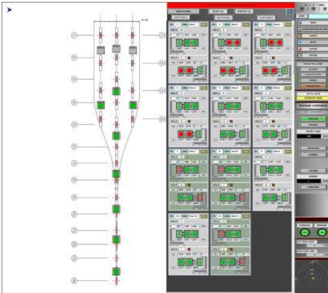
1. Videata di Movicon che rappresenta la prua della nave con la collocazione delle Skid-shoes
