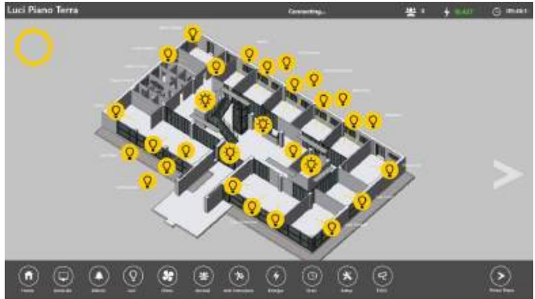
*L'illuminazione dell'edificio è completamente gestita a Led e connessa al supervisore tramite bus KNX.*
