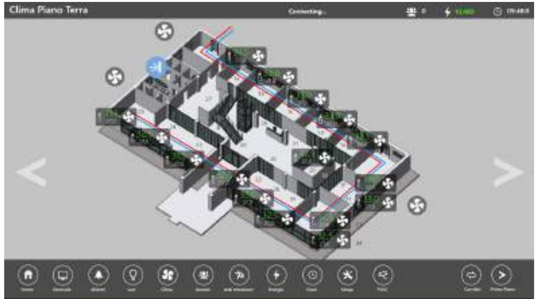
*Il sistema di climatizzazione è collegato al supervisore Movicon.NExT tramite bus BacNet/IP.*
