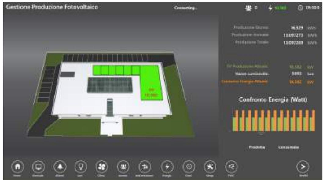
*L'efficienza energetica si basa su un impianto di produzione fotovoltaica, ed i consumi sono controllati dal sistema Pro.Energy.*
