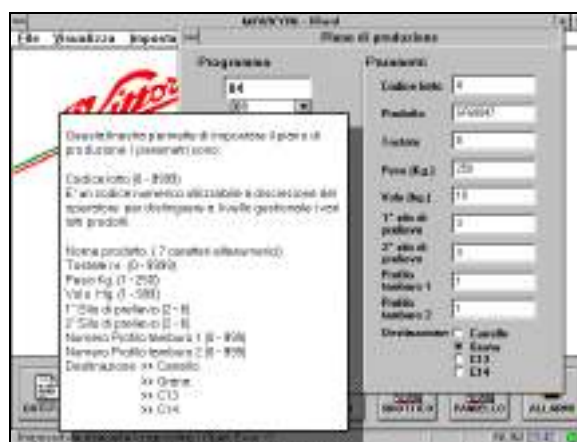
La finestra di dialogo di MOVICON per l'impostazione del piano di produzione con l'help personalizzato per l'operatore
