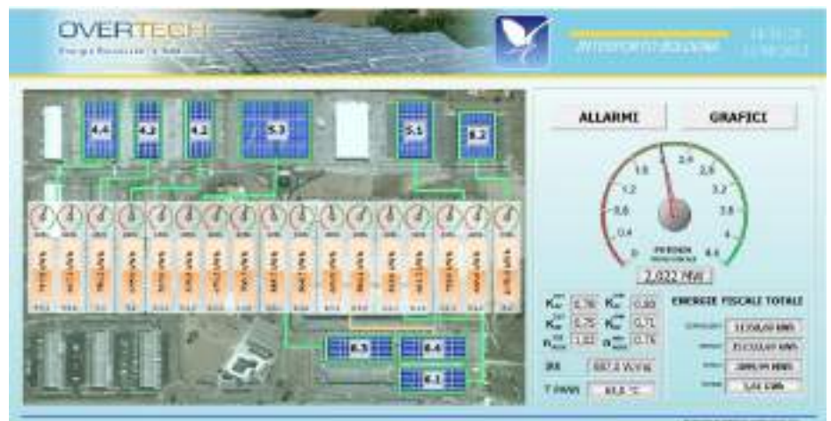
Sinottico generale del sistema di supervisione del grande impianto fotovoltaico dell'Interporto di Bologna, basato sulla tecnologia Scada di Movicon 11
