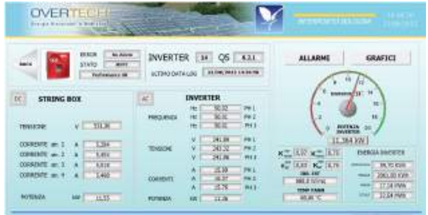
L'interfaccia utente di Movicon 11 consente all'operatore di disporre di tutte le funzionalità di impianto in modo chiaro ed intuitivo, anche via web.
