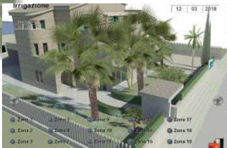
In questo caso sono stati creati ad hoc dei sinottici semplificati adatti a impartire comandi e visualizzare stati e allarmi sul campo direttamente sul cellulare. Gli allarmi e le notifiche vengono successivamente inviati ai cellulari dei responsabili tramite modem GSM attraverso l'opzione Alarm Dispatcher di Movicon.
