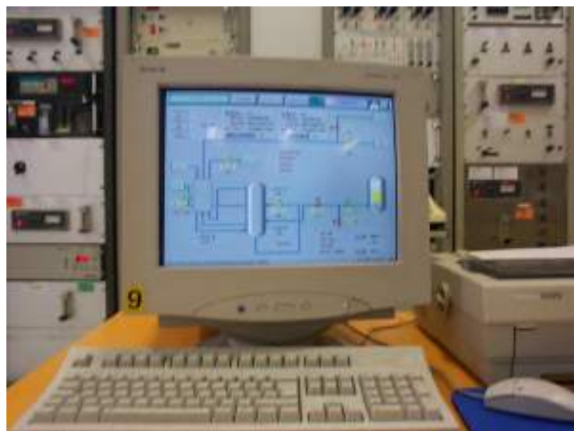
Una delle postazioni Movicon in sala controllo nello stabilimento Sapiro di Caponago (MI). In sala controllo è localizzato il server, connesso con il PLC concentratore sul quale confluiscono tutti i dati telemetrici.
