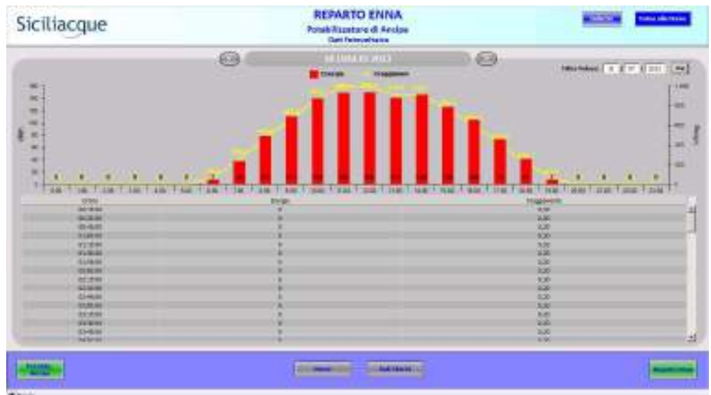
4. Dati del fotovoltaico del potabilizzatore di Ancipa. Registrazione dei dati energetici e di irraggiamento.
