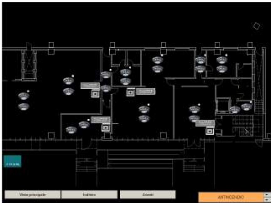
Una delle pagine del sistema di supervisione integrato. La visualizzazione di tutto il sistema è accessibile completamente in architettura web.
